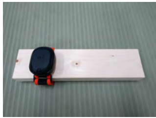
図 3 角材にトラッカーを取り付けた様子
