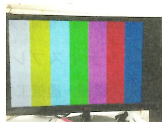
図 4: CmodA7 によるケーブル改良後の FullHD 出力
