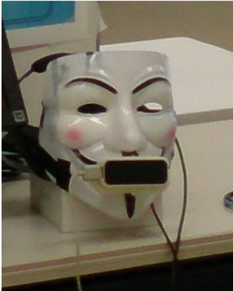
図 6.15: LeapMotion を取り付けたお面
